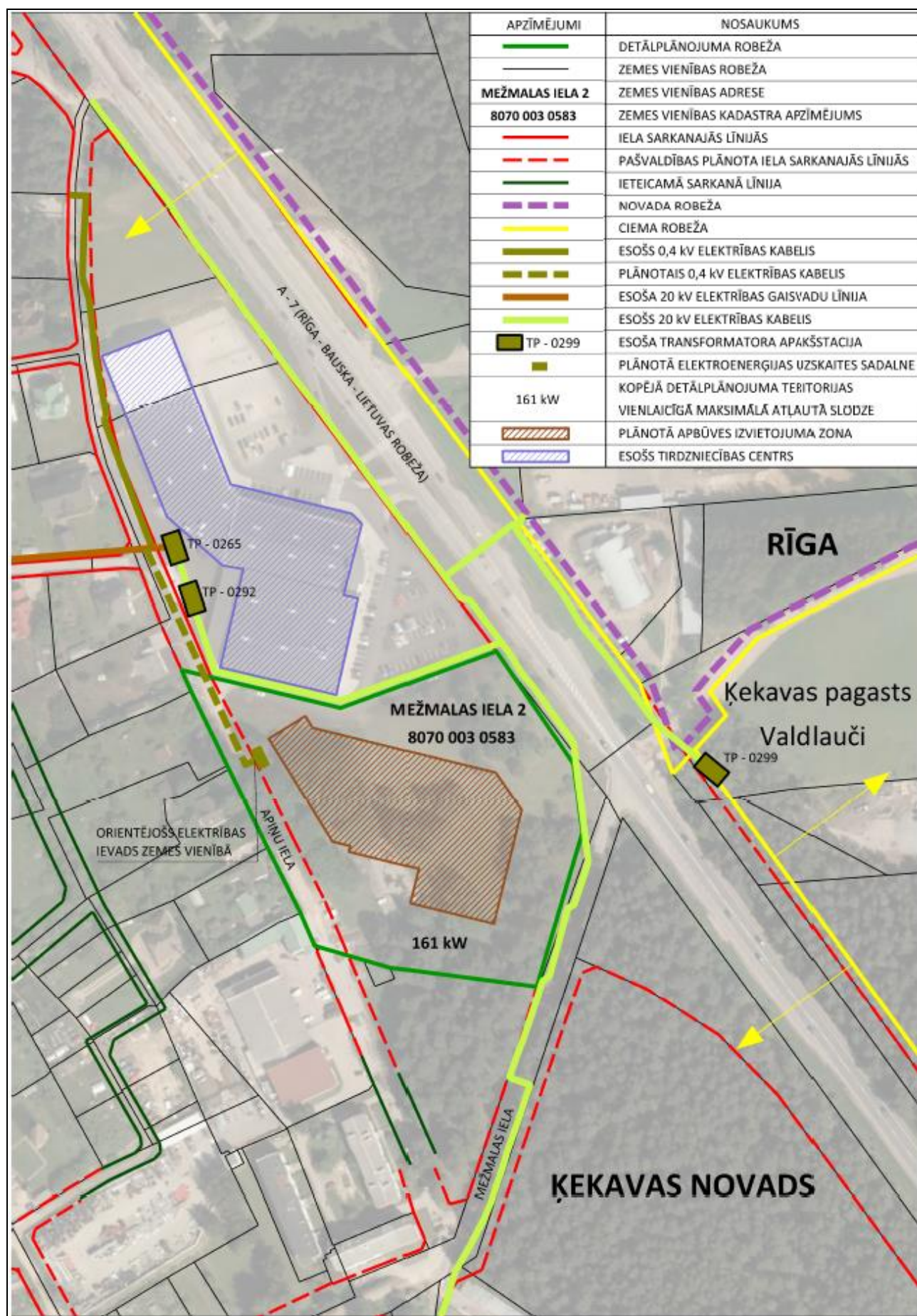
32.attēls. Elektroapgādes shēma.
